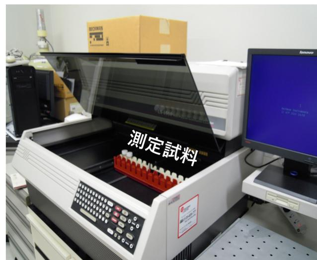
低エネルギーのβ線・γ線を測定できる。試料を液体シンチレーターに溶かし、β線・γ線との相互作用によって放出される光を測定する。三重水素(トリチウム)の測定も可能。
