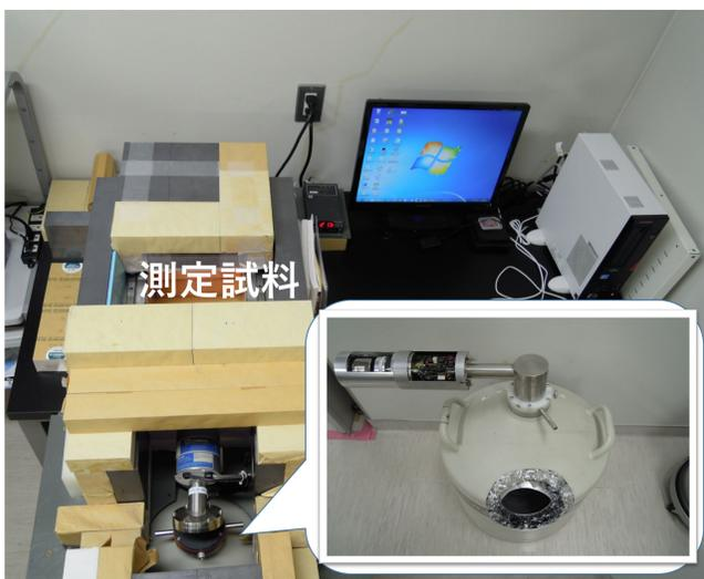
γ線・X線のエネルギーを測定できる。入射したγ線・X線がGe半導体内で変換され、そのエネルギーを分別する能力が高く、線源のRIを特定できる。
