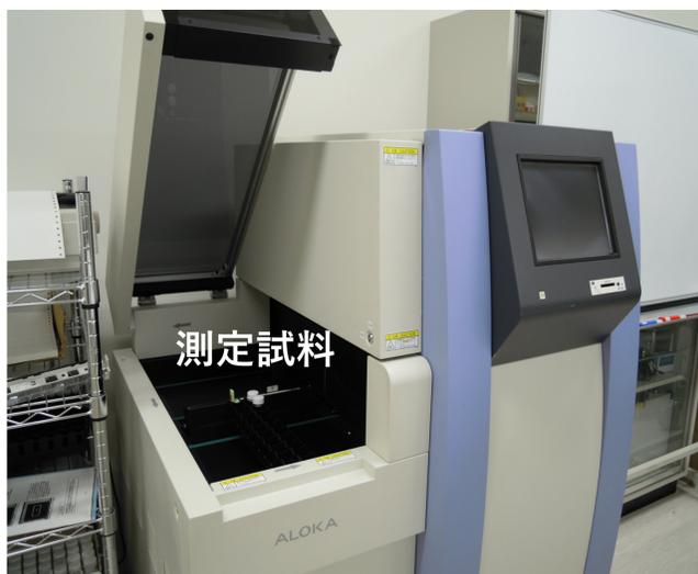
γ線・X線のエネルギーを測定できる。入射したγ線・X線と発光物質(シンチレーター)との相互作用によって放出される光を測定し、その計数の感度が高い。
