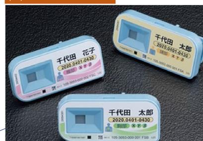
RIを使用する実験開始前に「ガラスバッジ」を着用する。ガラスバッジで実験者の被ばく線量が測定・管理される。
